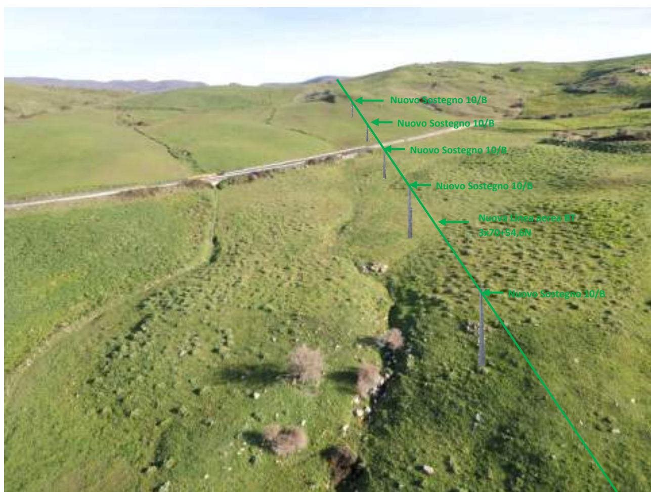
Foto 12 – Foto con vista dei luoghi con nuova linea aerea BT e nuovi sostegni.
